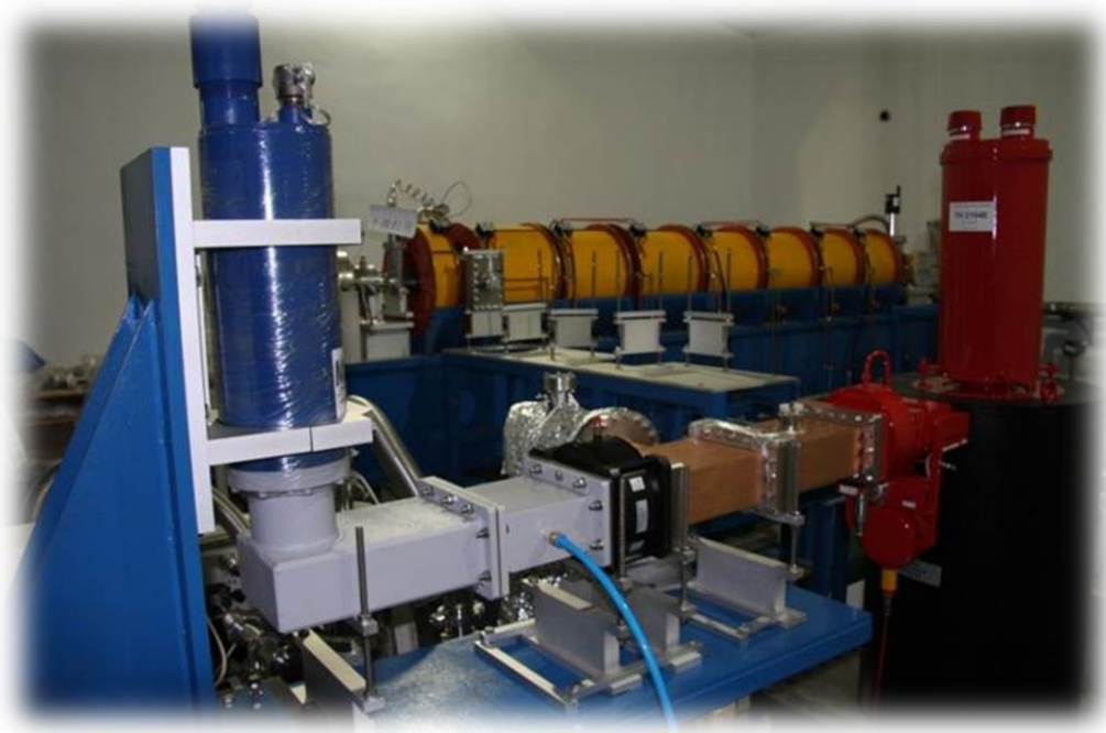
left: El Pont 10MeV/20kW S-Band Linac; right: El Pont 10MeV/40kW L-Band Linac
